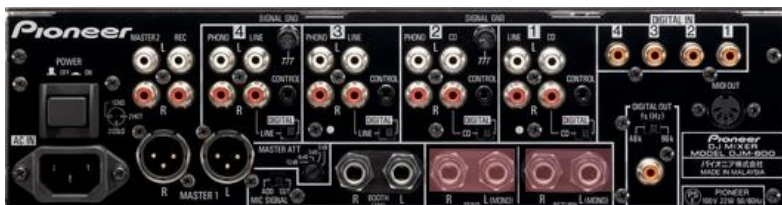
Pioneer DJM-800, trasero con conectores de envío y retorno
